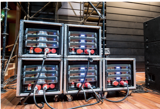
파워앰프 및 DSP는 메인스피커의 경우 Crown I-Tech 4x35000i, 서브우퍼는 I-Tech 12000i 사용되었다.
